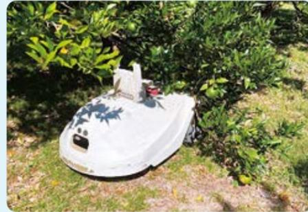
バッテリーを動力源に1時間の充電で1時間ほど稼働する(写真：指宿市役所提供)
