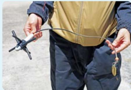
分娩時期に合わせて、臍内に温度センサーを挿入する。体温の変化をメールで知らせてくれる
