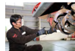
爪先の幅が約20mm以下になったら交換目安です
