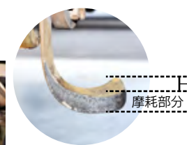
爪先の幅が約20mm以下になったら交換目安です
